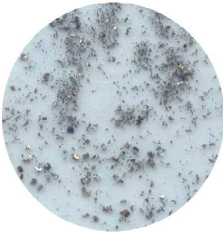
Filtermembran mit metallischen und nicht metallischen Partikeln aus einem Hydraulikrohr 16x2 mm
