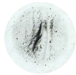
Restverschmutzung aus ungereinigtem Hydraulikschlauch
