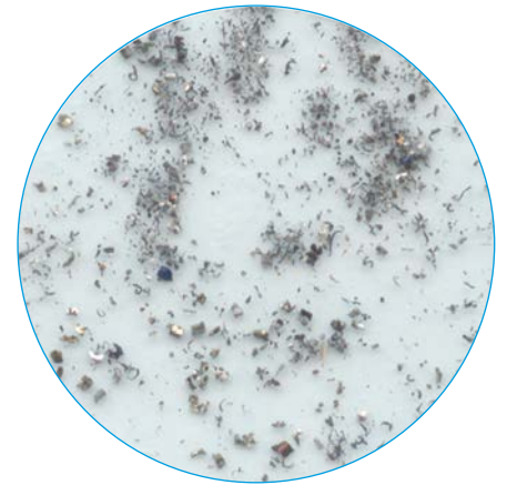
Metallische Partikel aus einem beidseitig geschnittenen Hydraulikrohr
