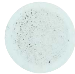
Mit Druckluft ausgeblasen
